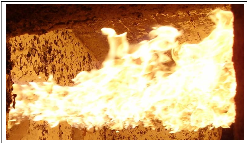
Горелка ESA A.G.O. в кислородно-топливном режиме
