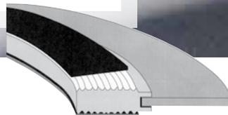
Прокладки на зубчатом основании состоят из металлического корпуса и мягкого уплотнения. Металлический корпус, как правило, сделан из нержавеющей стали, а материалом поверхности выступает, например, графит, ПТФЭ или керамика.
