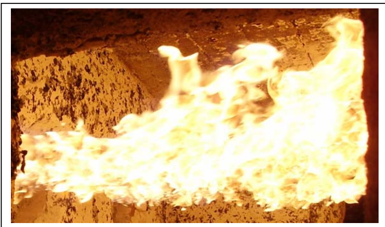
ESA A.G.O.: Форма кислородно-газового пламени
